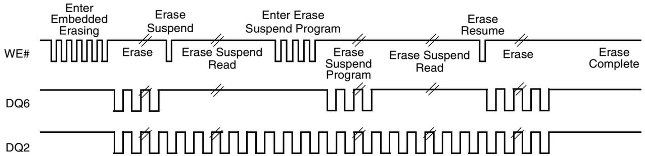
**Note:** The system may use OE# or CE# to toggle DQ2 and DQ6. DQ2 must be read at an address within the erase-suspended sector.
